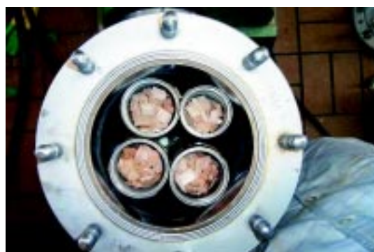
Figura 3. Vista superior del digestor con chips en el interior de las cápsulas
