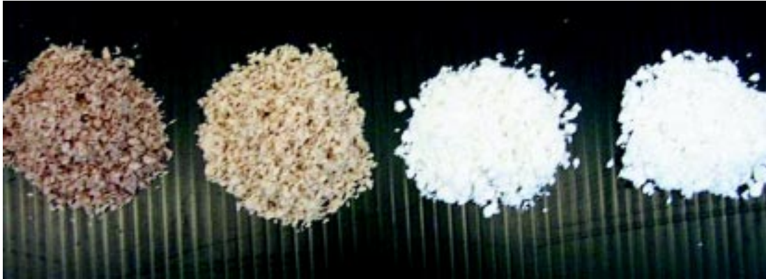
Figura 6. Pulpas con diferentes niveles de remoción de la lignina residual
