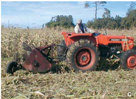
Figura 45 b y c. Trituradora y desmalezadora.
