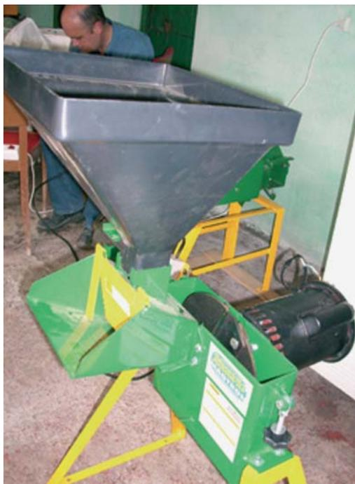
**Figura 2.** Cortadora y moledora eléctrica.
