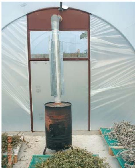
Otra forma es fijar en la estructura del secadero una chapa con una abertura circular de 10 cm de diámetro por donde saldrá la chimenea de la estufa
