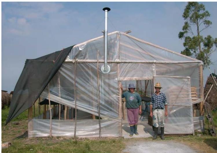
**Figura 12.** Invernadero tradicional adaptado como secadero con estufa y piso de hormigón.
