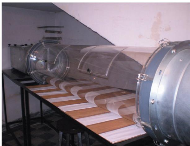
**Figura 4.** Túnel de viento del Laboratorio de Ecología Química (Facultad de Química, UdelaR; en comodato de INIA).
