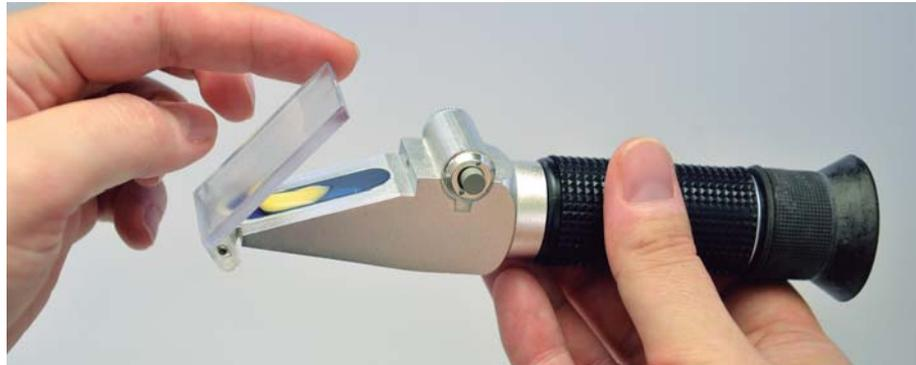
**Figura 17.** Cierre de la tapa sobre la superficie óptica del refractómetro.
