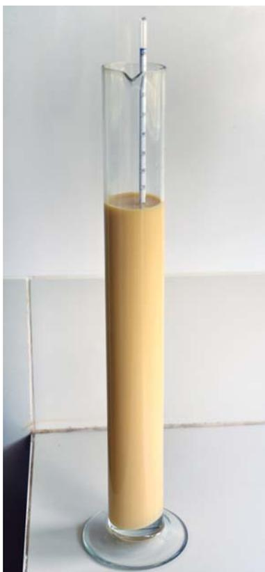
**Figura 14.** Densímetro sumergido en una probeta que contiene calostro.
