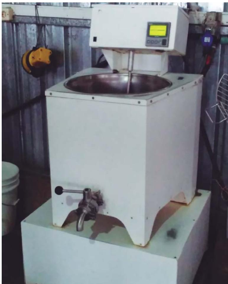
**Figura 7.** Pasteurizador de calostro.
