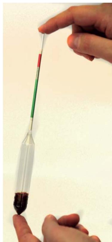
**Figura 15.** Densímetro con escala de lectura en colores.
