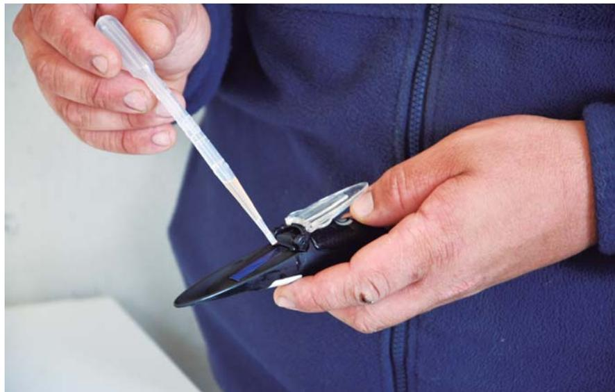
**Figura 22.** Colocación de suero en la superficie óptica del refractómetro.
