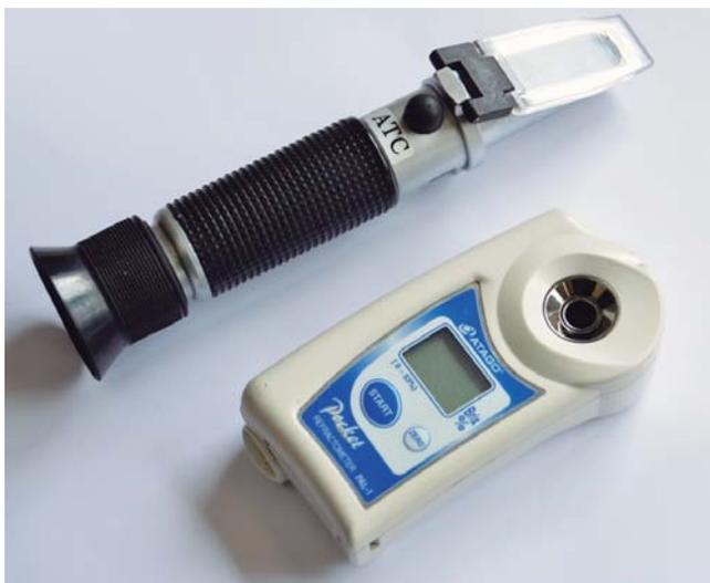
Figura 4. Refractómetro óptico (arriba) y digital (abajo).
