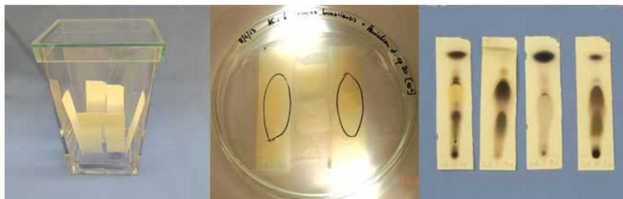
**Figura 6** - Cromatografía en capa fina para identificación de compuestos antifúngicos en aceites esenciales.
