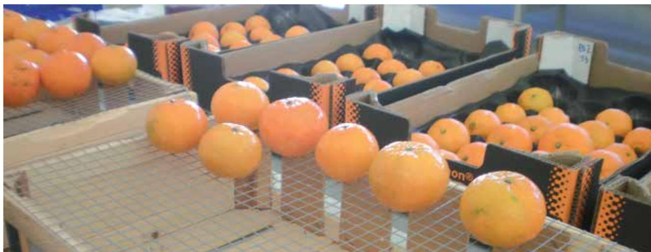
**Figura 7** - Vista general de un ensayo para evaluar un recubrimiento para fruta cítrica que incorpora un aceite esencial con efecto fungicida. Se observa la fruta con el recubrimiento aplicado y previo al secado.
