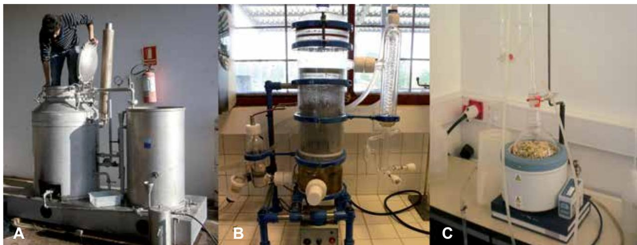
**Figura 1** - Diferentes tipos de destiladores de aceites esenciales. Capacidades: A = 100 L., B = 5L, C = 2L
