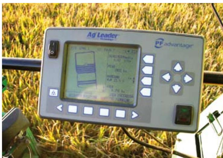
**Figura 2.** Monitor de rendimiento instalado sobre cosechadora comercial.
