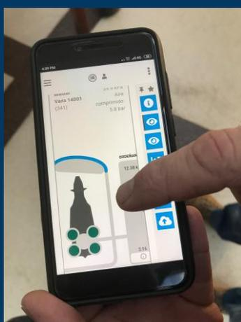
Imagen de la aplicación móvil del robot, desde donde el tambero recibe información específica y en tiempo real sobre cada vaca.
