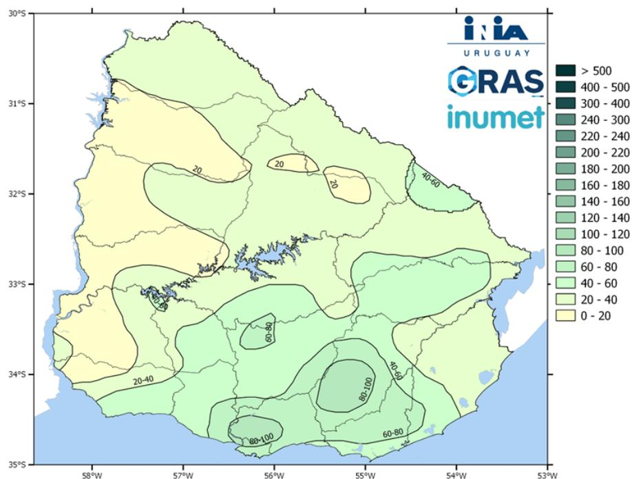
Otra salida del modelo de balance hídrico es el Agua no retenida en el suelo, la cual se define como la suma del Escorrentamiento superficial y Excesos de agua en el suelo (Agua que excede el contenido de agua del suelo a capacidad de campo).
