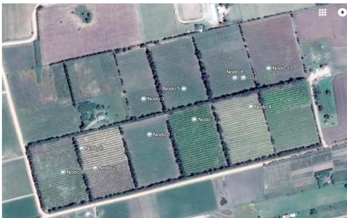
Figura 3.14. Ubicación de los nodos de la red instalados en el predio considerado en Margat Canelones.
