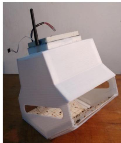
**Figura 3.9.** Fotografía de la última versión de la trampa construida en cartonplast.
