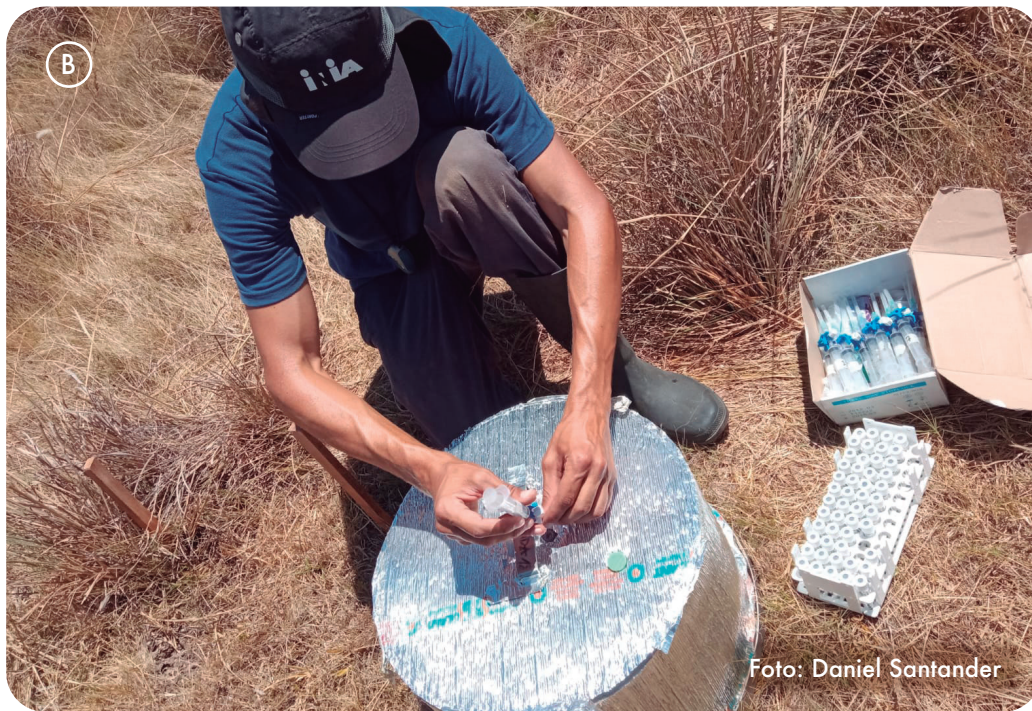
Figura 8 – A) Investigación nacional a través de cámaras, con el objetivo de medir emisiones de óxido nitroso y evolución de nitrógeno mineral en suelo, producto del agregado de nitrógeno a través de la aplicación de orina. B) Cierre de cámaras y toma de muestras de N_2O en campo natural tras aplicación de orina bovina.
