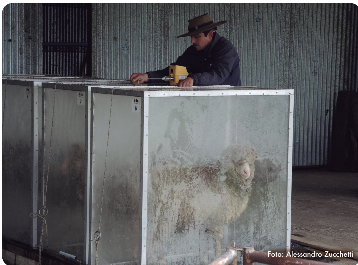
Figura 7 - Determinación de emisión de metano en ovinos en breves períodos de tiempo.
