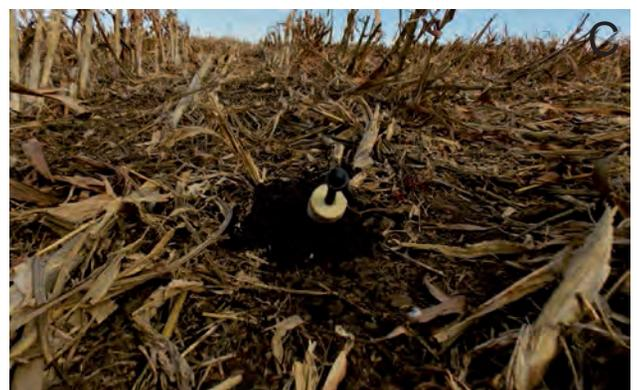
**Figura 2** - A) Construcción del túnel con un barreno para introducir la copas; B) Generación de vacío en el interior de la copa; C) Copa instalada en el campo bajo cultivo de sorgo cosechado.
