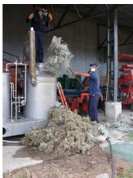
Figura 5: Destilador tipo alambique utilizado para obtener los AE
