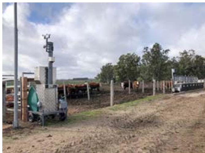
**Figura 3.** Unidad de medición de metano entérico en los corrales en los cuales se desarrollan las pruebas de eficiencia de conversión.
