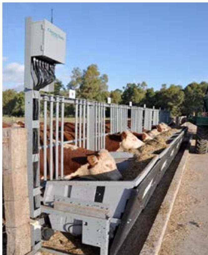
**Figura 2.** Comederos automáticos para la medición de consumo de alimento automático instalados en la Central de Pruebas de Kiyú.
