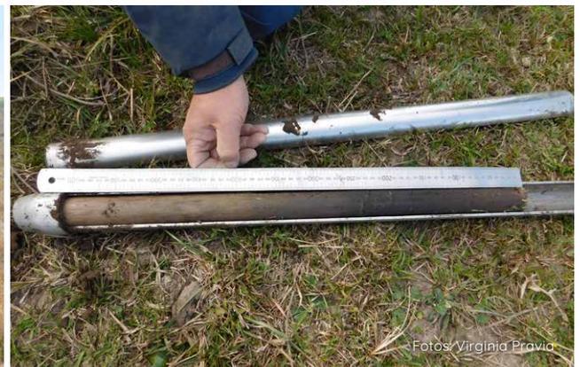
**Figura 1** - Muestreo de suelo con calador hidráulico.
