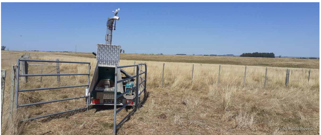
Figura 3 - Dispositivo GreenFeed para determinación de emisiones de metano ubicado en parcela de campo natural.
