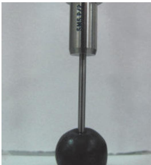
**Figura 11.** Medida de punción en la zona ecuatorial de arándano, expresada como fuerza máxima (Sonda P/2).
