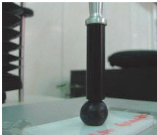
**Figura 12.** Medida de compresión en la zona ecuatorial de arándano, expresada como fuerza máxima (Sonda P/10).
